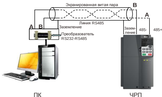
Рис. 9-1 Схема подключения RS485 для сети с одним ЧРП
